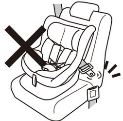
④ 車両のシートベルトが、ベルト通し穴の位置より前にある座席
