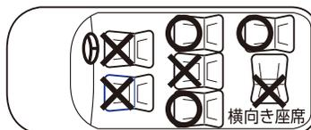
●助手席にはエアバッグが装備されています。エアバッグの作動により大きな衝撃を受けるおそれがあるため、必ず後部座席に取り付けてください。
