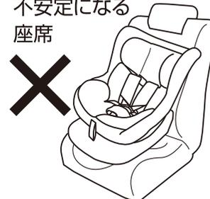
⑥ 車両シートベルトガイドにタンクが干渉し、バックルにしっかり固定できない座席
