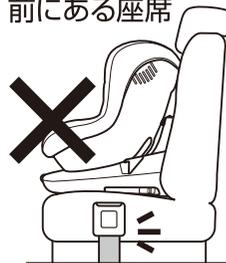
⑤ 座面の凹凸が極端で取り付けたときに不安定になる座席
