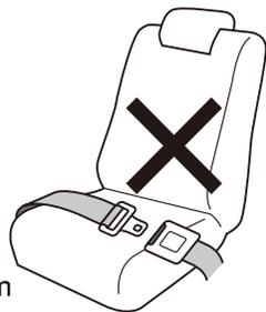
③ シートベルトの長さが極端に短いため、取り付けできない座席
